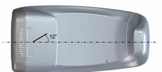
Rysunek 3: Kąt docelowy głowicy lampy (widok od dołu)
