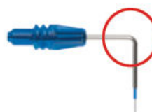
Rysunek 7.10 Wygięcie kaniuli końcówki
